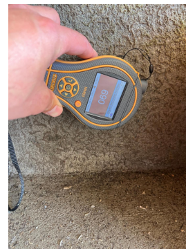
Fukt/vannspeil på gulv under befaring
