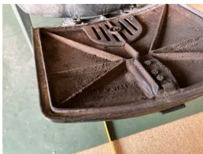
Mangler tettelst på ovnsdør, dørlås er også slakk
