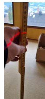
Måling av planavvik i stue. Laserstrek viser 1133mm.
