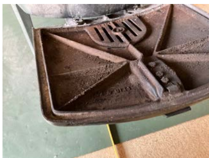
Mangler tetteliste på ovnsdør, dørlås er også slakk
