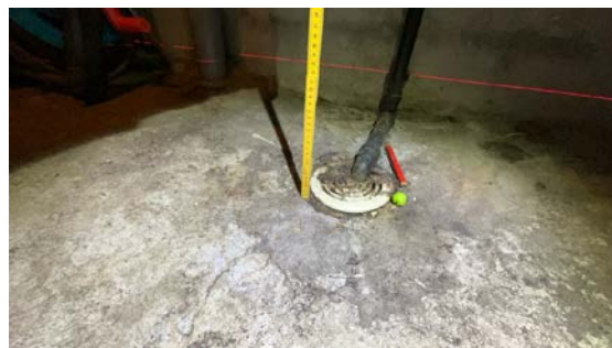
Laserstrek viser 142mm ved sluk.
