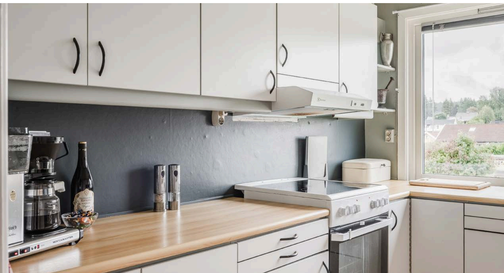
Kjøkkeninnredning har lyse glatte fronter og laminert benkeplate med nedfelt oppvaskum. plass til frittstående hvitevarer. Ventilator med mekanisk vifte og avtrekk ført ut mot fri.
