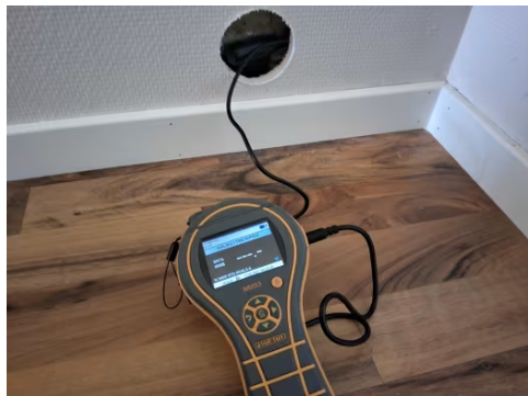
Bilde fra fuktmåling i veggkonstruksjon tilstøtende våtsone.
