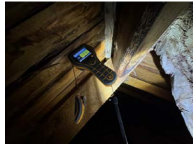
Fuktmåling i fuktskjold.
