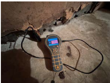
Fuktmåling i nedkanten av veggen.
