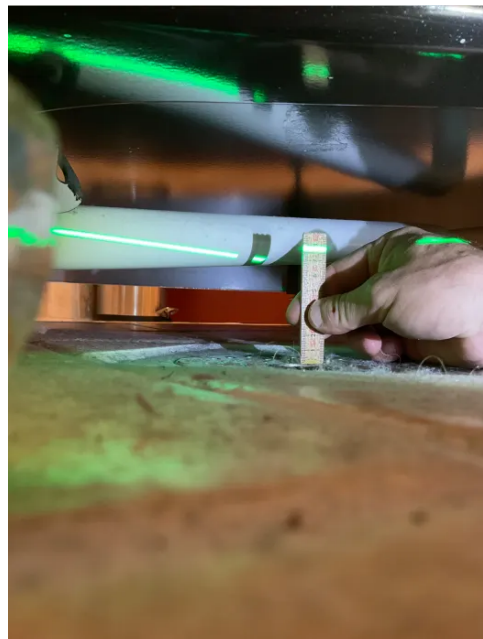
Tilfredsstillende fallforhold til sluk
