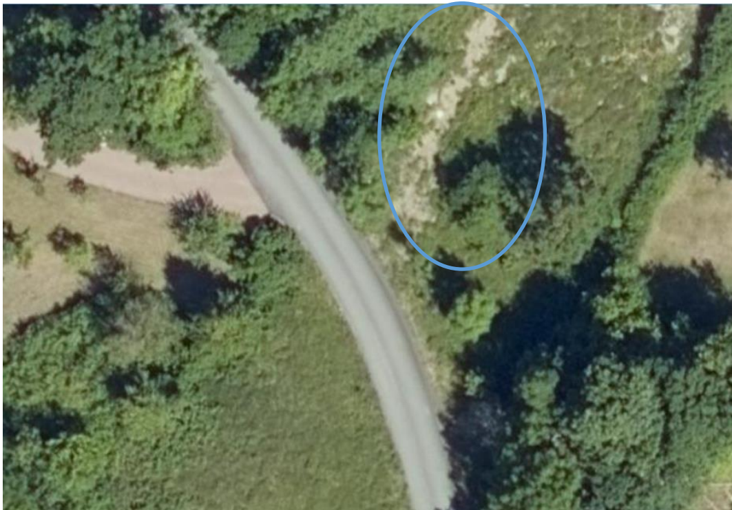
Figur 3. Flybilde fra 2017. Her vises gravearbeidet i forbindelse med nytt vannrør (innenfor blå ellipse). Kilde: kart.finn.no
