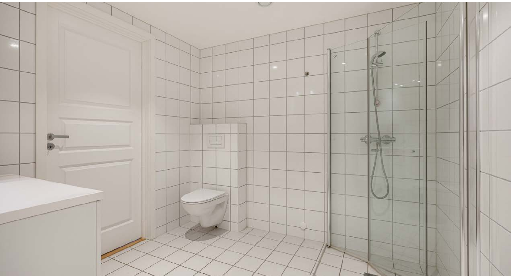
Dusjen er plassert i et hjørne og har innfellbare dører og veggmontert hånddusj. Toalettet er vegghengt.
