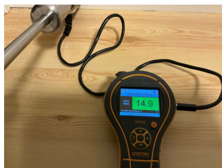
Kjøkken: Måling av fukt i treverk.
