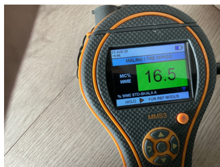
Kjøkken: Måling av fukt i treverk.
