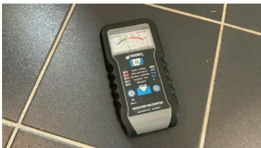
Ved fuktsøk på gulv er det ikke registrert måleverdier som indikerer fukt.
