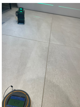
Fuktmåling rett innenfor døren
