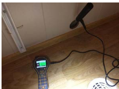
Ved fuktmåling registrerte jeg tørre verdier.
