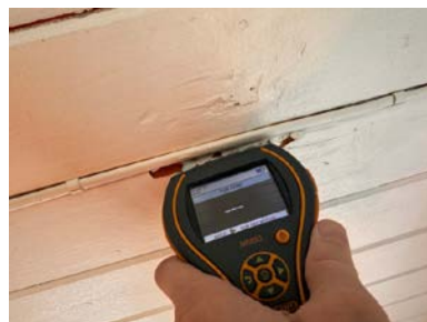
Malingflass i spisestuetak, ingen fukt.
