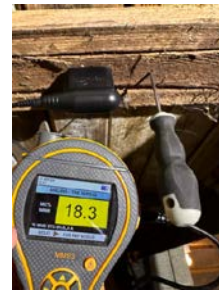
Registrert litt fuktighet samt råte i bjelkelag
