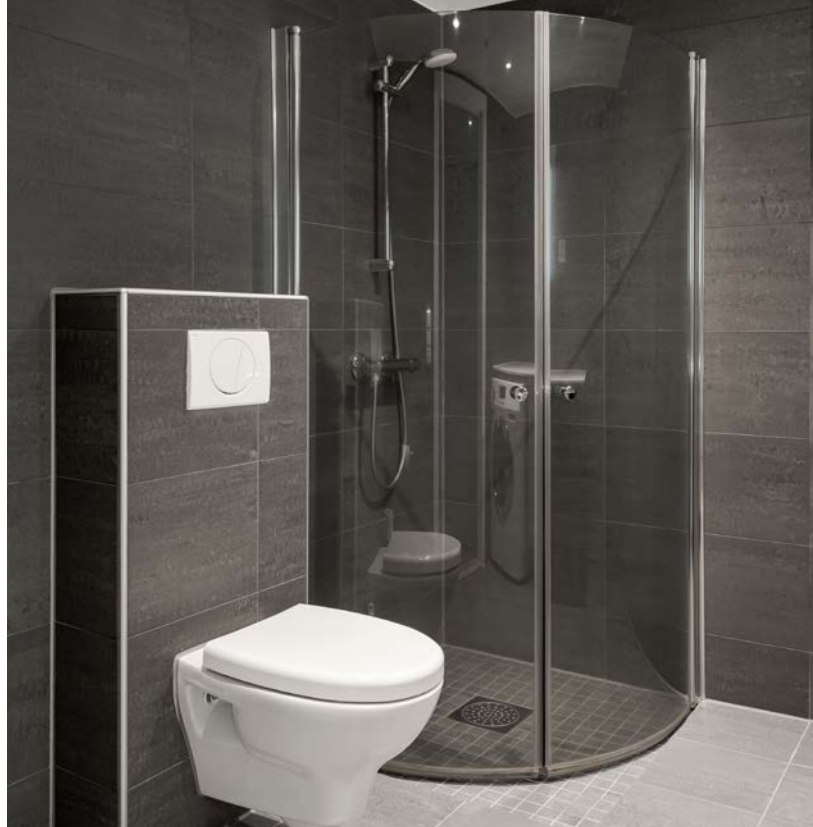
Baderom 2 har flislagte overflater, vegghengt toalett og dusjnise med glassvegger.
