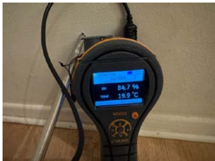
Måling av relativ luftfuktighet.
