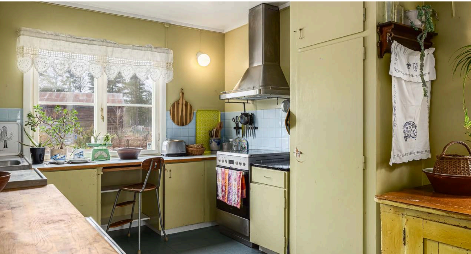
Praktisk med fliser i benkeryggen og ventilator med avkast via yttervegg.
