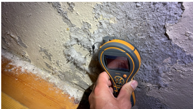
Ved overflatesøk med fuktmåler var det fuktskjolder
