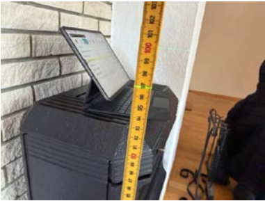
Stue 97 cm. Totalt avvik på ca. 20 mm.
