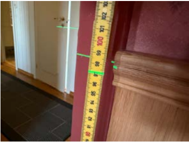
Soverom sørvest 97,3 cm. Totalt avvik på ca. 11 mm.
