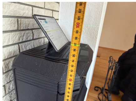
Stue 97 cm. Totalt avvik på ca. 20 mm.
