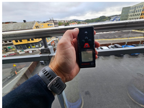
Rekkverket er målt til ca.133cm
