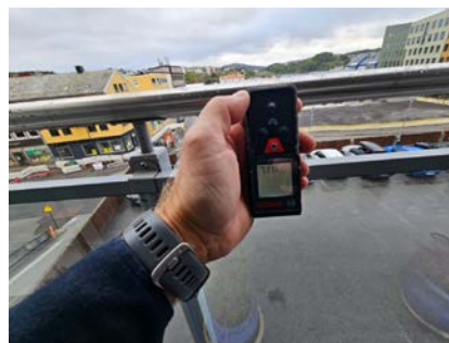
Rekkverket er målt til ca.133cm
