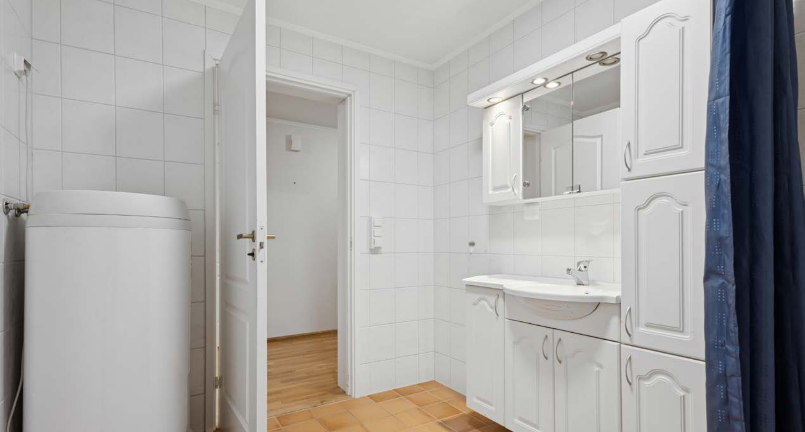
Badet har mekanisk avtrekk og innredning med nedfelt servant og opplegg for vaskemaskin.
