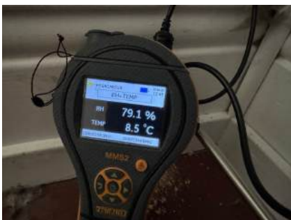
Måling av relativ luftfuktighet.
