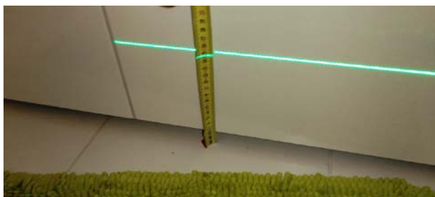
Kontroll av fall mot sluk.
