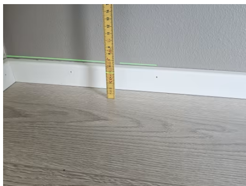
Etasjeskiller er kontrollert med nivelleringslaser.
