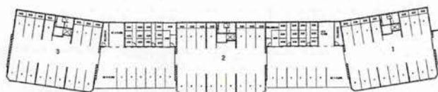
PARKERINGSETASJE MED MELLOMVEGG
