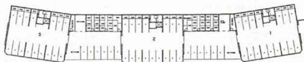
PARKERINGSETASJE MED MELLOMVEGG
