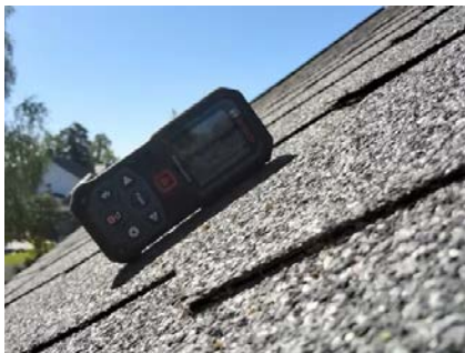
Takvinkel er målt til 32 grader.
