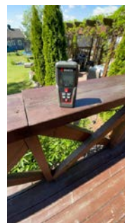
Rekkverkshøyde terrasse i 1. etg. 83 cm.
