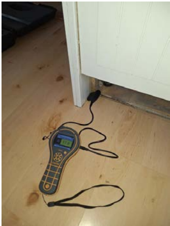
17,8%noe forhøyet verdig i bunn av dekk side.
