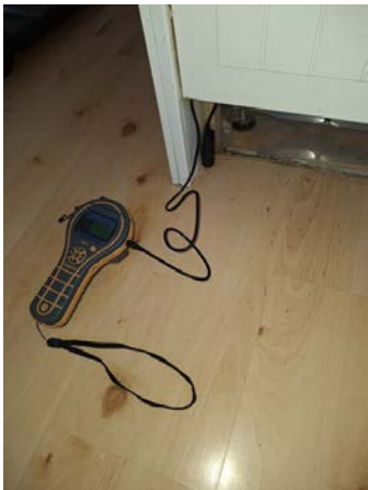
Måler tørt på sponbit som står opp langs dekk siden. Ser visuelt at denne har vært våt.
