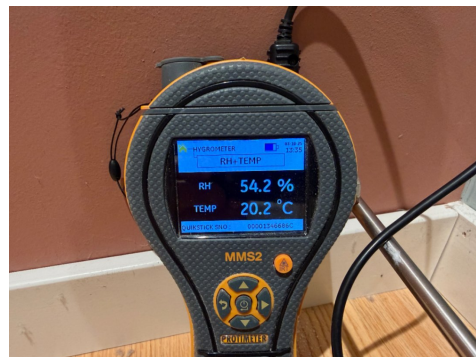
Måling av relativ luftfuktighet.
