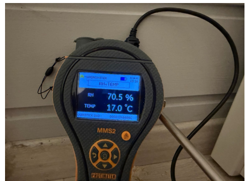
Måling av relativ luftfuktighet.
