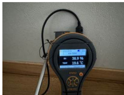
Måling av relativ luftfuktighet.
