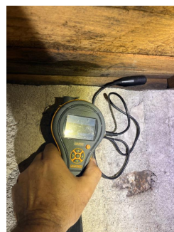
Målt i svill under bjelkelaget, 17,9 vekt%
