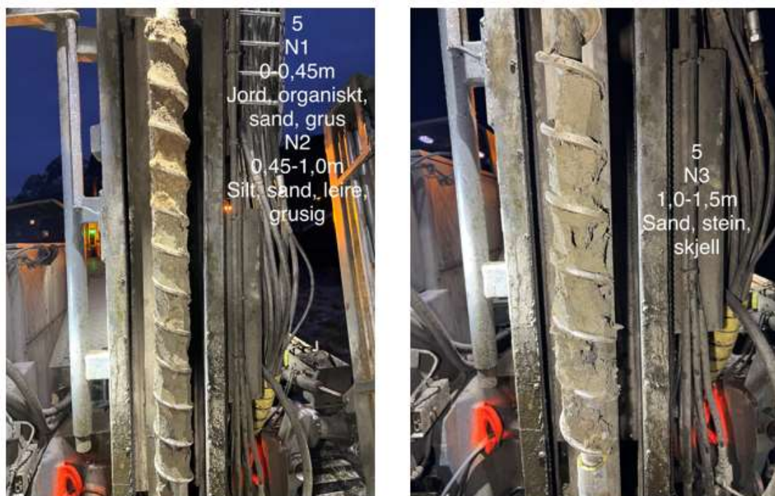
Figur 5: Utførte naverboringer ved borpunkt 05
