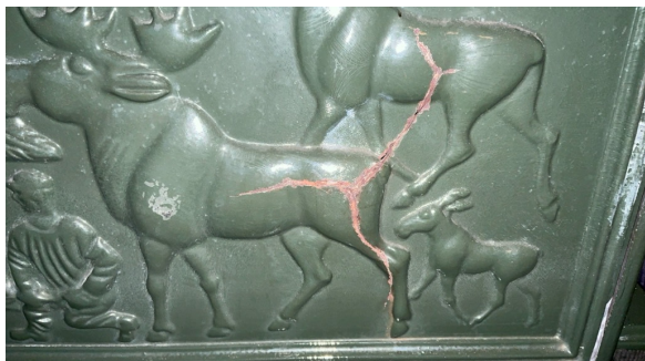
Sprekker i ovn
