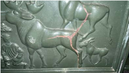
Sprekker i ovn
