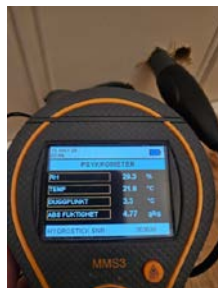
Måling av relativ luftfuktighet i lukket veggkonstruksjon mellom soverom og dusjsone.
