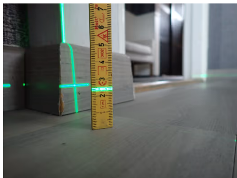
Referansenivå laser = 4 cm. Viser høydeforskjell på ca. 16 mm i stue i 1. etasje.
