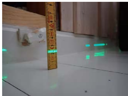
Referansenivå laser = 4 cm. Viser høydeforskjell på ca. 17 mm i loftstue.
