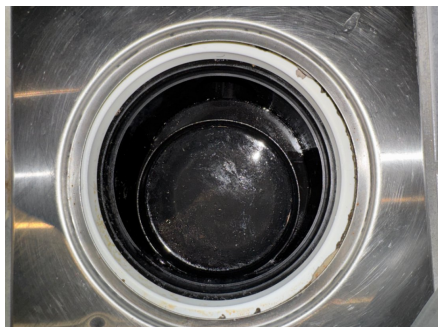
Plastsluk med klemring og synlig membran/mansjett
