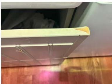
Slitasje merker på dør til oppvaskmaskin.
