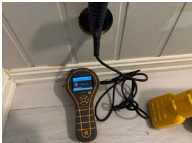
Fuktmåling med pigg mot våtrom: Det ble ikke målt forhøyde fuktverdier ved hulltaking på befaringstidspunktet.
