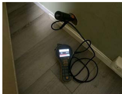
Utført hulltaking på rom under terreng.
