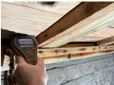
Fritt vann i ytterkant av bjelkelaget.
