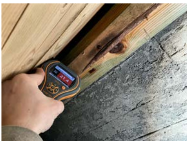
Fritt vann i ytterkant av bjelkelaget.
