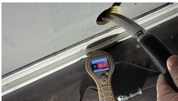
Fukt påvist ved fuktmåling i kjellerstuen
