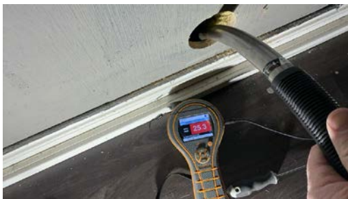
Fukt påvist ved fuktmåling i kjellerstuen
