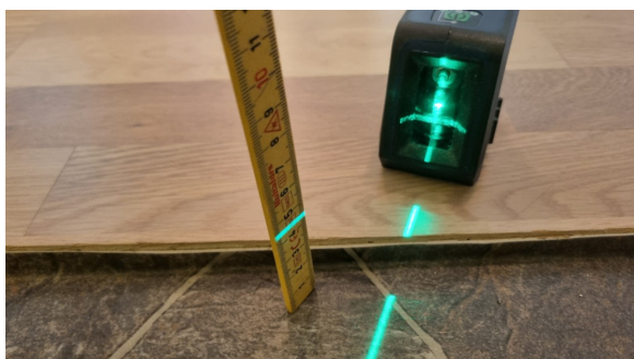
Kontroll av fall/høydeforskjell.
