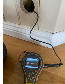
Fuktmåling uten utslag på måler, det vil si under 6%
