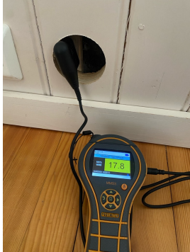
Fuktmåling i utforet vegg under terreng
